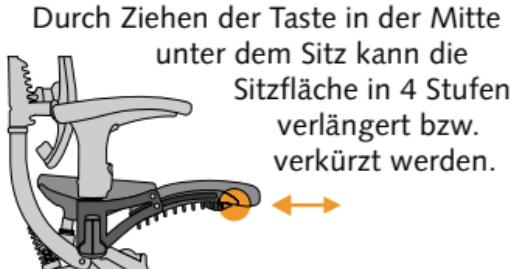
Durch Ziehen der Taste in der Mitte unter dem Sitz kann die Sitzfläche in 4 Stufen verlängert bzw. verkürzt werden.
