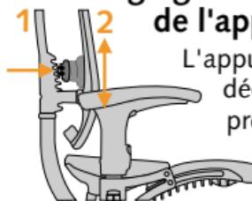
L'appui lombaire est déclenché par simple pression vers l'avant et est réglable en hauteur.
